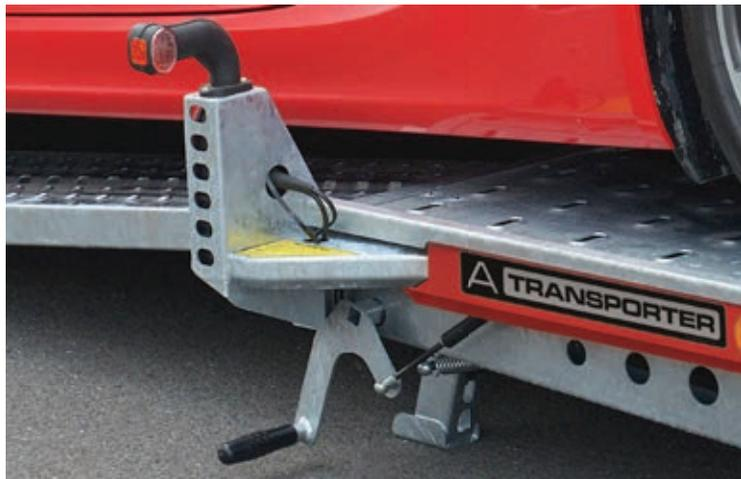
● **Heckstützen mit Fußpedal-Bedienung** sichern die Rampen (eingeklappt), sekundenschnelles Ausklappen per Fuß (und zugleich Entriegelung) – doppelte Funktion bei bequemster Bedienung.
