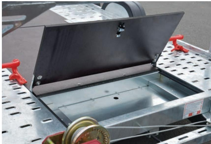
● Front-Bodenstaubox - abschließbare Bodenbox mit Federunterstützten Deckel.
