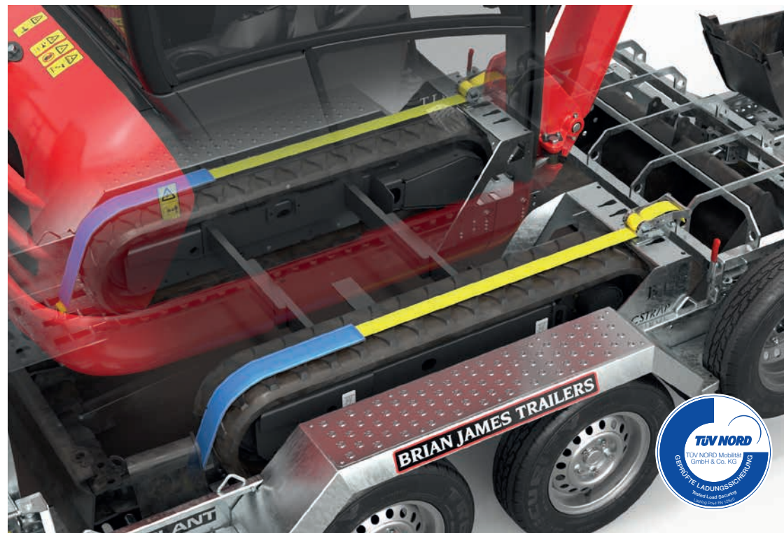
○ TracStrap System Das neue BJT TracStrap Ladungssicherungssystem für Minibagger und andere Kettenfahrzeuge ist einzigartig und exklusiv verfügbar für den Digger Plant. Ein revolutionäres System, welches eine erstklassige Sicherung innerhalb kürzester Zeit erlaubt und zudem vom TÜV Nord zertifiziert wurde (Prüfbericht 8114838799). Die vorderen Keile sind verstellbar und bilden die Basis der Formschlüssigen Ladungssicherung. Jede Kette wird durch einen bis zu 10 Tonnen belastbaren 75mm breiten Gurt (gelb) fixiert.
