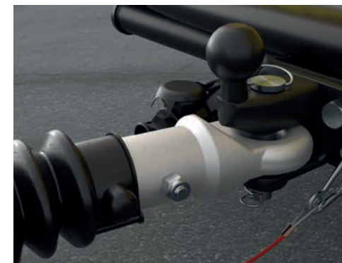
○ Zugöse 40mm. Bei Bedarf können sie den Digger Plant auch mit einer Zugöse ausstatten.
