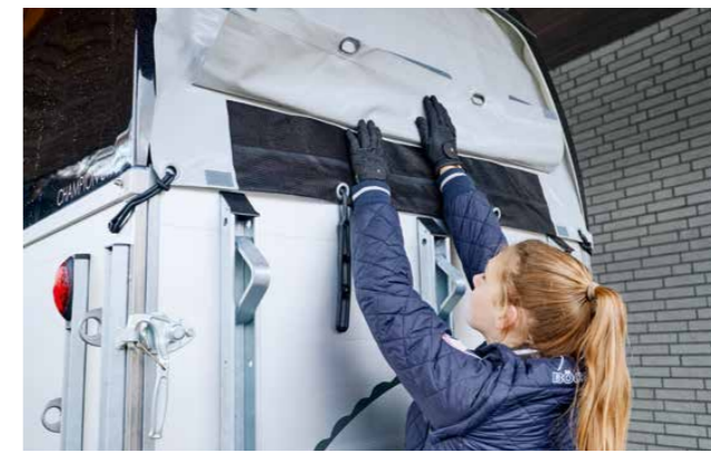
Planenlift mit integriertem Netz und Aufrollfunktion.
