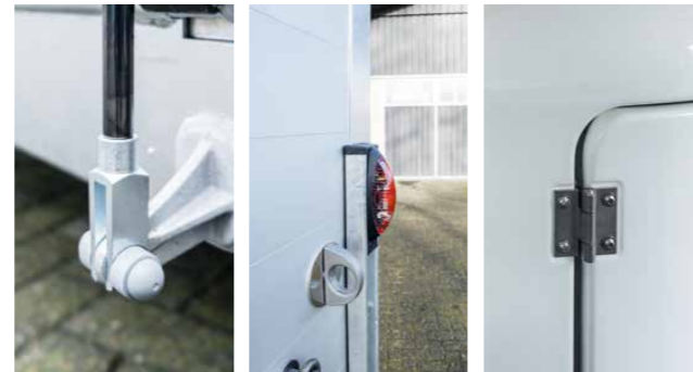
Keine scharfen Kanten und Ecken durch abgerundete Scharniere und Kunststoffabdeckungen an den Stahlprofilstreben und an den Enden der Heckstreben.
